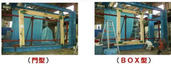
図4 実大試験（建築センター） ※最大6.37m →J'リット'工法は10m実施
